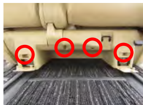
6 シートレール部のカバーをヘラや先の細いマイナスドライバー等で開き、赤丸で示す箇所のネジをプラスドライバーで緩め取り外します。
