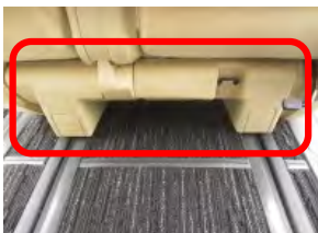
5 シート後方の台座のプラスチックカバー部を取り外します。
