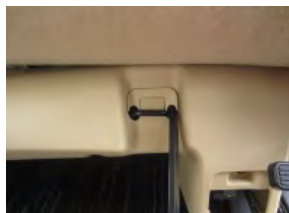
7 チャイルドシートフック部奥のプラスチックカバーを外します。ツメが弱いのでヘラや先の細いマイナスドライバー等で慎重に取り外して下さい。
