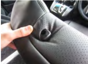
5 カバーの穴よりヘッドレストの台座を取り出します。生地への伸びを利用し慎重に行ってください。
