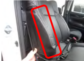
6 カバーのWSテッチ部とシートの側面(張り出している面)のラインをしっかりと合わせます。
