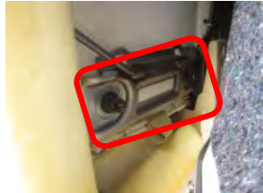
3 開いた隙間からナットが見えます。ソケットレンチで緩め取り外します。(ナットサイズ12mm)
