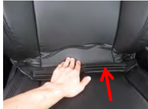
7 座面との隙間にカバーを入れ込みます。 ※入れ込むカバーの先端にブラフックが付いています。フックで生地を傷つけないように注意して下さい。
