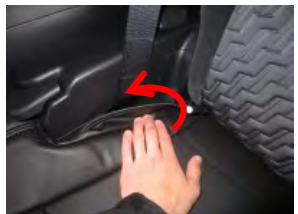
4 外側面のカバーをシートとプラスチックの隙間に入れ込みます。
