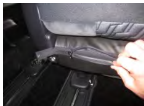
7 5で引き出したカバーと6で後ろにまわしたカバーのチャックを閉じます。チャックを閉じる際は各々の生地をしっかりとたぐり寄せながら閉じて下さい。
