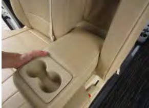
9 アームレストを取り付けナットを締め固定します。 (アームレストカバーの取付は12ページを参照)
