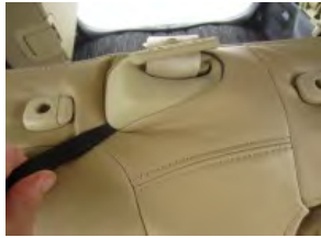
6 センターシートベルトの台座の下にカバーを入れ込みます。生地伸びを利用して角から入れ込んで下さい。
