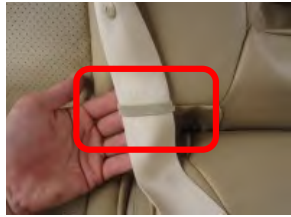
7 カバーのゴムバンドにシートベルトを通し、外した反対の手順でシートベルトを取り付けます。
