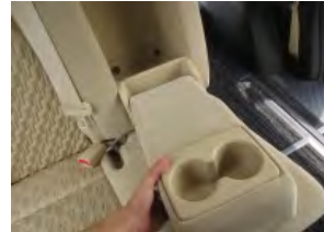
4 アームレストを手前に引き出し取り外します。
