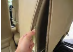
10 純正シートのチャックを閉じ、余ったチャックは純正生地の内側の入れ込みます。
