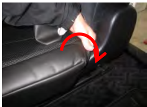
2 内側面の後方角にカバーをしっかり和被せます。
