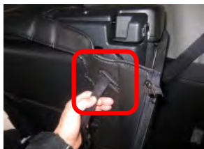
6 シートを跳ね上げ、シート裏面のカバーを後方にまわし、カバーの穴よりシート固定用のバックルを取り出します。
