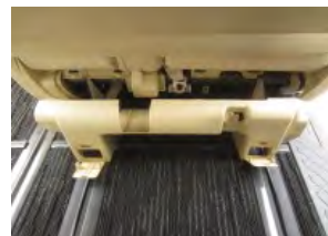
8 カバーを手前に引き取り外します。
