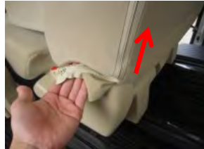
2 内側面の純正生地のチャックを中から引き出し、チャックを開きます。
