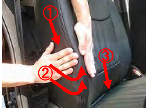
9 背もたれ側面のカバーを、画像の①～③の順番にシートの形状(ライン)に合うまで繰り返し均して下さい。 ※画像は他の車種です。
