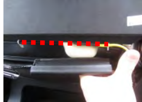
10 8で引き出したカバーのブラフックをサイドエアバッグの配線を避けながらシートの赤線部に引っ掛け固定します。
