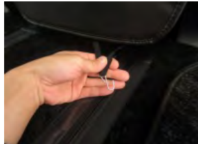
15 バックポケット下のカバー先端のゴムバンドに付属のS字フックを取り付け、シート裏の金属部に引っ掛け固定します。
