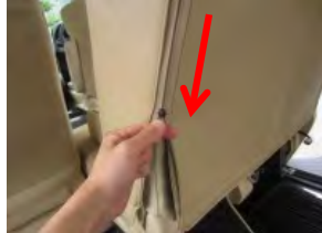
11 カバー側面の生地をたぐり寄せ、チャックを閉じます。
