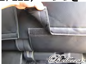
6、4で引き出したカバーもマジックテープで固定します。
