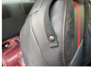
14 カバー加工穴の位置を合わせシートベルトガイドを固定します。3で緩めたリクライニングレバーをカバーの上から固定します。
