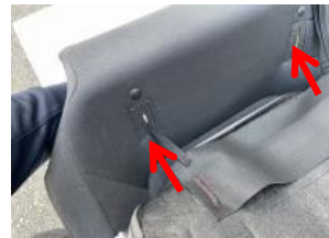
8 カバー裏に付いているゴムバンドをチャイルドシート固定用フックの穴に通します。
