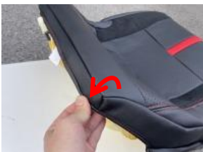
9 シートの角に被せるようにラインを合わせます。
