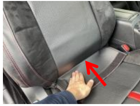
11 座面との隙間にカバーを入れ込みます。
