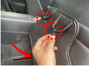
13 背面下のカバーのゴムに付属のS字フックを取り付け、シート裏の金属部分に引っ掛け固定します。
