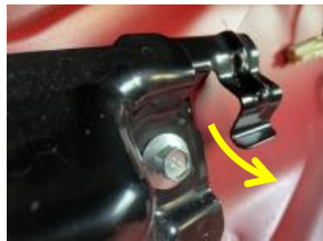
6 座面を固定している金具を拡大した画像です。矢印方向にシートをずらす事で座面が外れます。
