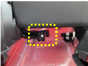
5 座面を固定している金具の位置です。
