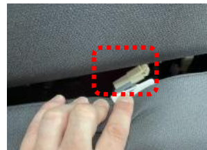
4 シート裏でカブラーが繋がっているのがわかるのでカブラーを外します。
