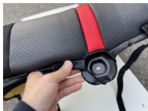
10 シート固定ボルト部に紐をくぐらせます。
