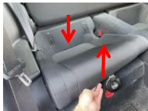
3 座面手前を持ち上げながら座面奥を下に押さえるとシートが外れます。
