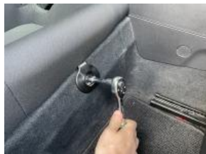
2 ソケットレンチ(10mm)を使用し、ボルトを緩めます。
