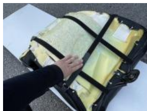
11 シートを裏返しベルトを固定します。※ベルトはあまり強く締めずにシート裏に添うようにして下さい。強く締めすぎると車両に戻す際に妨げになります。
