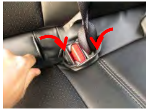
18 シートベルトバックル周りのカバーを入れ込みます。シートベルトをバックルに差し込み引っ張りながら作業すると入れ込みやすくなります。
