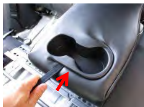
7 ドリンクホルダー周りのカバーをヘラ等を使用しプラスチックの隙間に入れ込みます。
