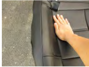
11 10の作業時、シートの立ち上がり部のカバーを押さえながら作業するときれいにラインに添います。
