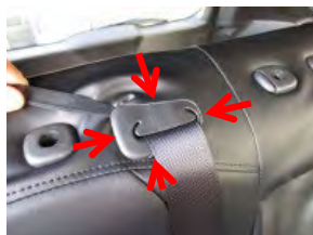
3 ヘラを使用し中央シートベルトのプラスチック部の下に生地を入れ込みます。
