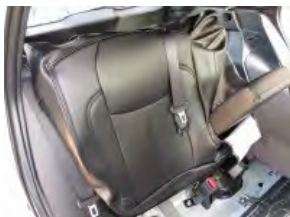
1 カバーのファスナーを開き、シートのラインに合わせてながら被せます。アームレストはカバーの穴から出しておきます。
