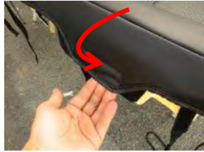
10 カバー後方のマジックテープは、シート本体に直接貼り付けて固定します。
