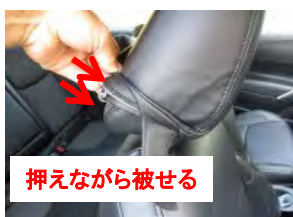
2 ヘッドレスト下側はカバーがきつくなるので、ヘッドレスト本体を押さえながら慎重に被せていきます。
