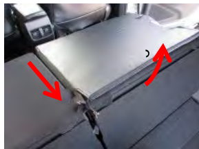
7 シートを倒し、6で入れ込んだカバーをシート後方より引き出します。側面のファスナーを閉じます。ファスナーの先端はカバーの中に入れ込みます。
