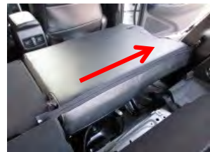
8 7で引き出したカバーと背面のカバーのファスナーを閉じて固定します。ファスナーの両端はカバーの中に入れ込みます。
