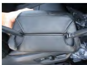
3 ヘッドレスト裏のマジックテープを貼り合わせブラックを固定します。
