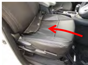
3 シートのラインに合わせてながら前からカバーを被せます。
