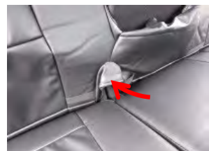
16 シートの軸部分のカバーを入れ込みます。カバーにはマジックテープが付いているので、シートに貼り付け固定します。
