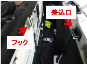
5 背面裏のフック位置を確認しておきます。シート裏側にフック、車体側に差込口があります。
