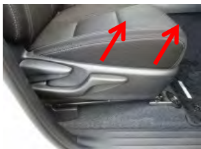
1 シートリフターを操作し、座面を一番高い位置まで上げます。
