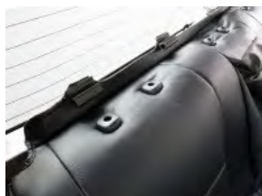
10 ヘッドレストの台座をカバーの加工穴から取り出します。
