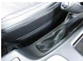
9 隙間が狭いのでシートをスライドさせ作業しやすい位置に調整しながら貼り付けます。
