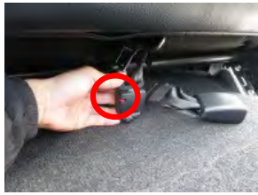
2 中央のシートベルトを外します。赤いロックボタンを付属のヘラ等で押すと外れます。
