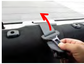
3 ロック解除したシートベルトを固定しているゴムから外します。
