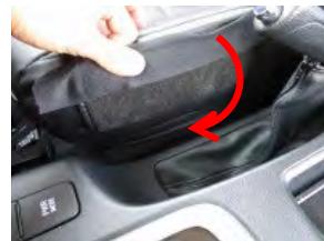
8 シート内側面のカバーに付いているマジックテープを直接シートに貼り付けて固定します。
