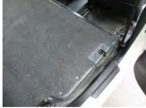
14 6でめくった生地を元に戻し、3で外したロック部分のプラスチック、4で外した金属プレートを取付け、5で外したプラスチックピンで生地を固定します。
