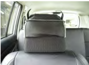
1 カバーを半分ほど裏返し被せませす。ヘッドレストをシートに取り付けた状態で作業すると力が入りやすくなります。
