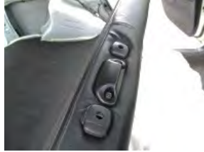
15 2で外したプラスチックパーツを取り付けます。
