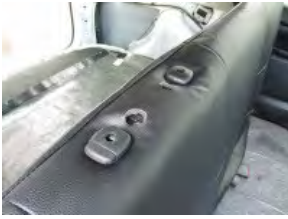
9 カバーの穴からヘッドレストの台座を取り出します。
