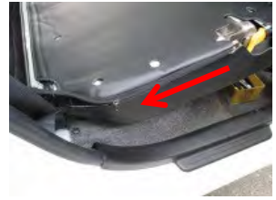
12 カバー側面のファスナーを閉じます。余った先端はカバーの中に入れ込みます。
