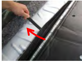
11 カバーにはベルトが付いています。ベルトを引っ張り入れ込んだカバーを引き出します。
