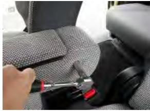
2 ソケットレンチを使用しボルトを緩めアームレストを取り外します。(ソケットサイズ:12mm)
