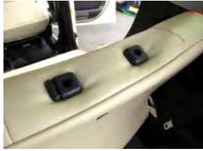
2 カバーの穴からヘッドレストの台座を取り出します。
