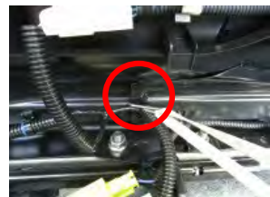
20 内側はコネクターを取り付けているステー付近に引っ掛け固定します。
