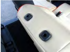
5 カバーの穴からヘッドレストの台座を取り出します。
