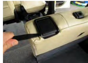
12 レバーとシートの隙間に生地を入れ込み、ネジを締めレバーを固定します。
