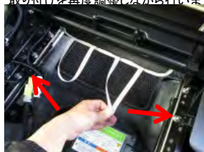
19 シート下のトレイを取り外し、背面下部のゴムをシートレール付近に固定します。
