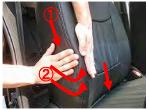
10 背もたれ側面のカバーを、画像の①～③の順番にシートの形状(ライン)に合うまで繰り返し均して下さい。 ※画像は他の車種です。
