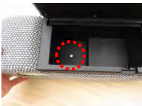
1 はじめに小物入れを取り外します。プラスドライバーを使用し中のネジを緩め外します。小物入れ無し車は次ページの「21」からを確認します。
