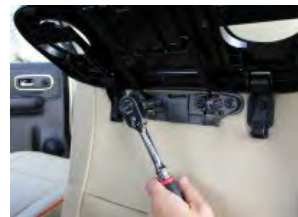
16 ボルトを固定します。締め付けすぎるとテーブルが破損するので注意してください。
