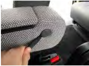
1 ヘラを使用しアームレスト側面のカバーを外します。
