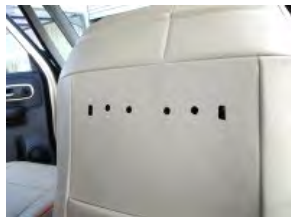
15 バックテーブル装備車は、カバーの穴とネジ穴位置が合っている事を確認しテーブルを取り付けます。 穴位置が合わない場合、カバーの取り付けを再度調整しながら行いま
