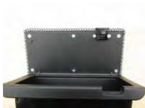
3 プラスドライバーを使用しフタ内側のネジを全て緩め小物入れからフタを取り外します。
