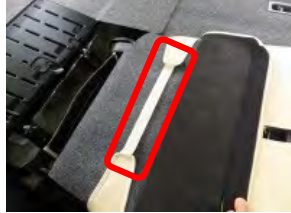
7 両側面のマジックテープを固定します。
