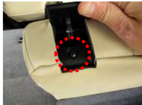
11 プラスドライバーを使用しリクライニングレバーのネジを緩めます。 ※ネジは緩めるだけで外しません。
