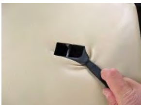
13 ヘラを使用しISO-FIXのアンカーのプラスチックカバーの下に生地を入れ込みます。
