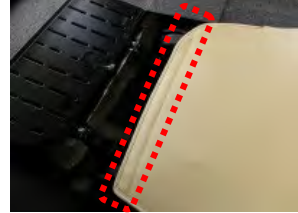
8 4で引き出したカバーと背面内側に付いているマジックテープを固定します。
