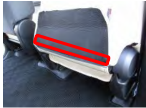
11 7で引き出したカバーと背面内側に付いているマジックテープを固定します。
