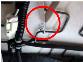
13 ゴムに付属のS字フックを取り付けシート裏の金属部に引っ掛け固定します。
