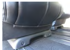
4 シート前方のカバーを、シートとプラスチック部の隙間に入れ込みます。
