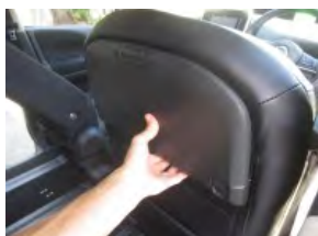
22 取り外したテーブルを取り付けます。テーブル周辺のカバーの厚みで戻しにくくなっております。テーブル上部のフックをシートに引っ掛け、下部を押さえ付けながら固定用ボルトにナットを仮締めします。
