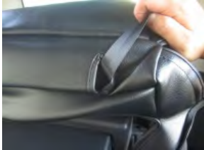
5 カバーの加工穴からシート裏のベルトを取り出します。
