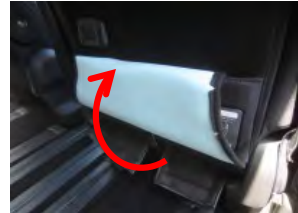
16 座面-1で外した純正生地を上へに捲りあげます。
