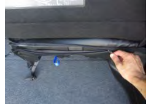
8 2で引き出したカバーとシート下部を通したカバーのチャックを閉じます。シートの構造上タイトな造りになっています。しっかりと生地をたぐり寄せチャックを閉じて下さい。
