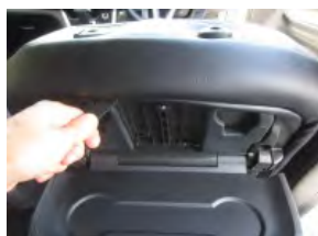
23 ヘラを使用しテーブル周辺の生地をシートとテーブルの隙間に入れ込みます。入れ込みが不十分だとテーブルを正しく格納できなくなります。テーブルを傷付けないように注意しながらしっかりと入れ込んで下さい。
