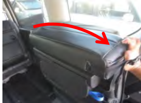
6 側面もシートとカバーをのラインをしっかりと合わせます。
