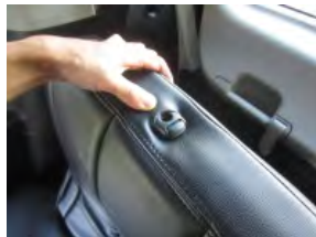
3 カバーの穴よりヘッドレストの台座を取り出します。
