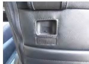
20 USBポート位置とカバーの穴位置がずれていないか確認します。穴位置がずれている場合、カバーの取り付け・固定をやり直し調整して下さい。 (USBポート未装備車は作業不要)
