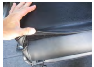
8 6で引き出したカバーと背面のマジックテープを固定します。
