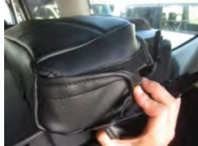
7 シート後方のカバーのマジックテープを固定します。
