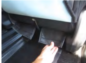
14 入れ込んだカバーを後ろから引き出します。
