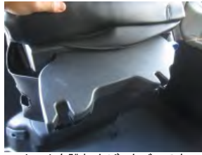
3 シートを跳ね上げ、カバーの加工部よりシートの台座部を取り出します。
