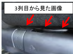
3 入れ込んだカバー先端のマジックテープをプラスチックカバー手前のシート部に貼り付け固定します。
