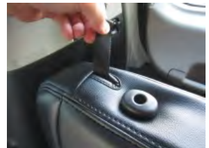
4 カバーの加工部よりリクライニングのベルトを取り出します。
