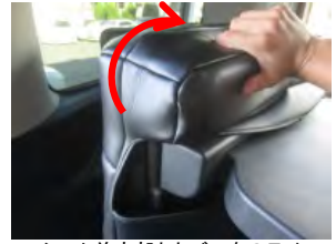
4 シート前方部とカバーをのラインをしっかりと合わせます。
