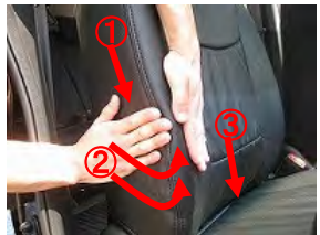
15 背もたれ側面のカバーを、画像の①～③の順番にシート形状(ライン)に合うまで繰り返し均して下さい。 ※画像は他の車種です。
