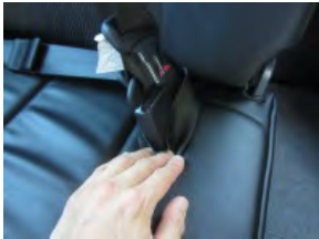
9 シートベルトバックル部の生地を折り返し入れ込みます。バックルを固定しシートベルトを引っ張りながらカバーを入れ込むと作業しやすくなります。
