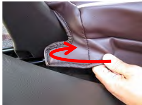
6 側面後方の生地を内側に折り返しマジックテープをシートに直接貼り付け固定します。 ※必ず側面のフックを固定する前に折り返しマジックテープを貼り付けて下さい。
