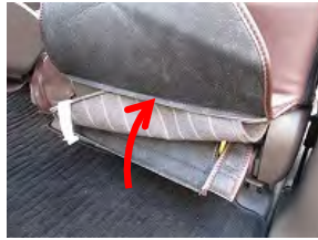
11 座面で外した純正生地をカバーの中に入れ込みます。
