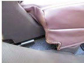
7 正しく折り返しマジックテープを固定できると画像のようになります。
