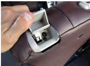
5 プラスドライバーを使用しクラインingleレバー内のネジを緩めます。※ネジは緩めるだけで取り外しません。
