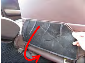
13 カバー先端に付いているゴムに付属のS字フックを取り付けシート裏の金属部に引っ掛け固定します。
