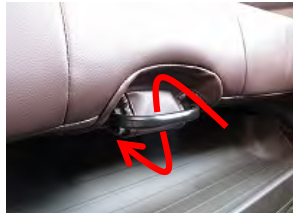
14 シートスライドレバー部の内側にカバーを通し、マジックテープを固定します。
