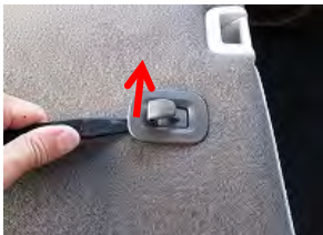
1 はじめに背面のコンビフックを外します。フックを出した状態で台座下部にヘラを差し込み真上に持ち上げます。
