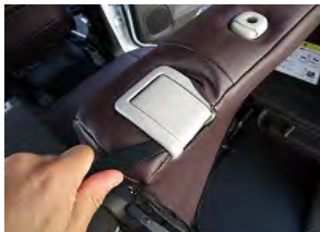
6 レバー周りの生地を入れ込み、再度ネジを締め付けます。※ネジを締めた際にレバー周りの生地にシワが入る場合、ネジを緩め生地を調整して下さい。
