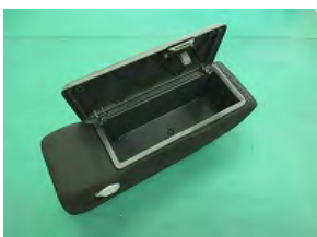
1 ブラスドライバーを使用し、小物入れの中のネジを緩め外します。
