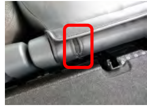
8 背面にレバーのある車両は、カバーの切れ込みで配線を逃してマジックテープを固定して下さい。
