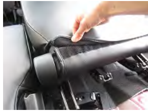
7 5で引き出したカバーと背面生地のマジックテープを貼り合わせ固定します。
