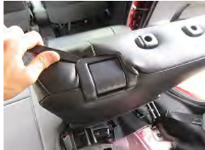
10 ヘラを使用しリクライニングレバーの下に生地を入れ込みます。カバーを入れ込んだ後ネジを締め付けます。
