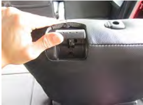
9 リクライニングレバーのネジを緩めます。 ※ネジは緩めるだけで取り外さないで下さい。
