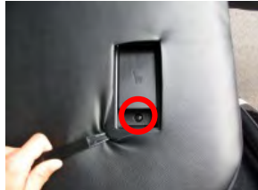
11 背面にレバーのある車両も同様にヘラを使用しレバー周りのプラスチックカバーの下に生地を入れ込みます。入れ込みにくい場合は丸部のネジを緩めると作業しやすくなります。
